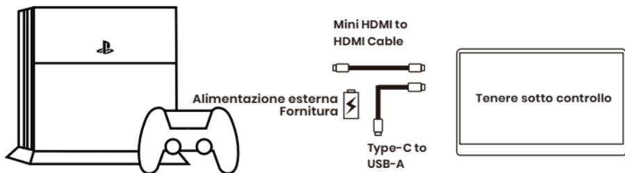
**Nota:** collegare prima il cavo di alimentazione e poi il Mini HDMI al cavo HDMI per garantire la trasmissione fluida dei segnali.
