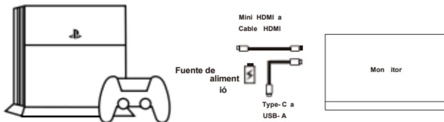
Tenga en cuenta que primero conecte el cable de alimentación y luego conecte el mini HDMI a la línea HDMI para garantizar una transmisión de señal fluida
